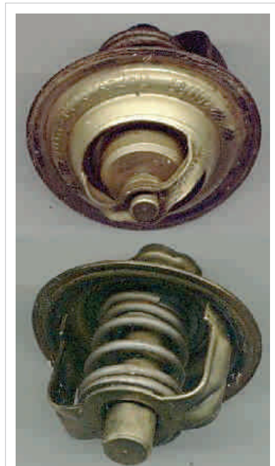
Termostato de parafina para radiadores de vehículos.
