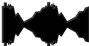
Fig.2 Señal de FI a la salida del sintonizador
