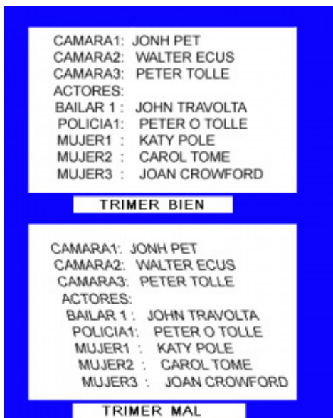
Fig.3 Ajuste del trimer del cristal de clock
