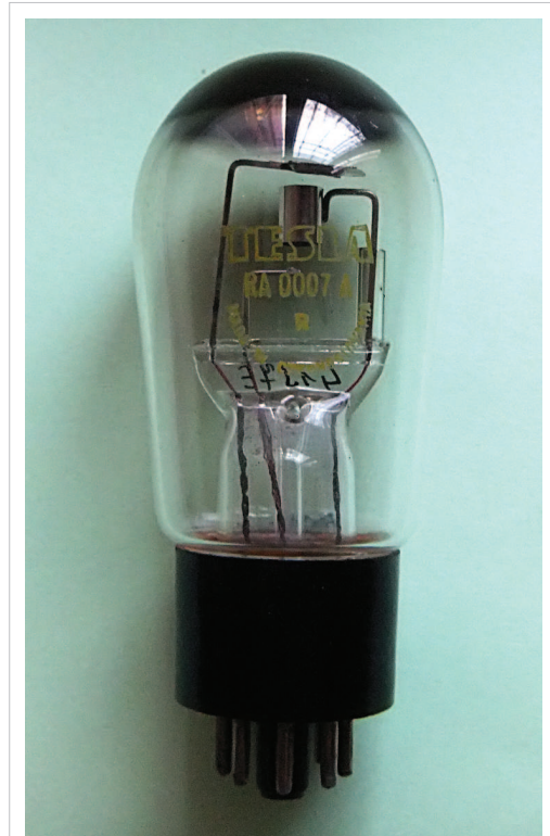
Diodo de vacío, usado comúnmente hasta la invención del diodo semiconductor, este último también llamado diodo sólido.
