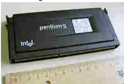
Intel Pentium II; se puede observar su estilo de zócalo diferente.
