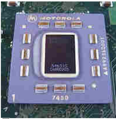
Empaquetado de un procesador PowerPC con Flip-Chip, se ve el chip de silicio.
