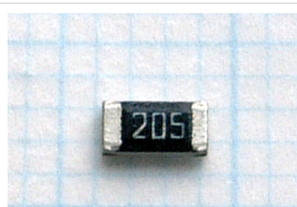
Resistencia de montaje superficial o SMD.
